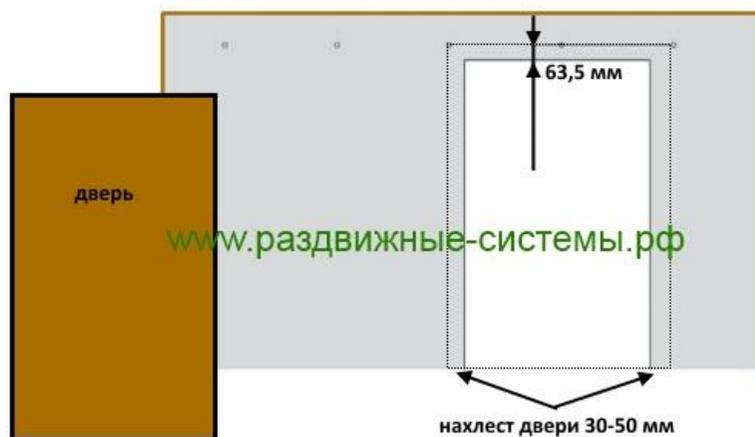
2. Сделать отверстия в стене под установку верхнего направляющего трека. Трек крепиться к стене 5 болтами. При монтаже используются дюбели, рекомендованные для данного типа стены.
