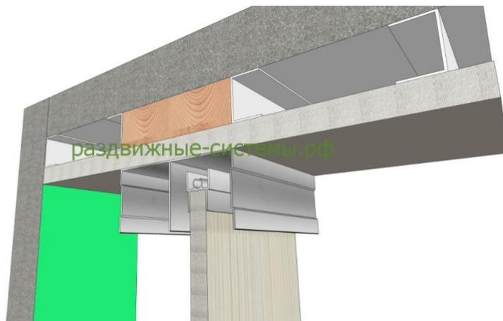
4. Потолок ГКЛ вровень с рельсой. При таком способе установки требуется предусмотреть некую нишу в потолке, учитывая габариты верхней направляющей. Габарит рельсы на картинке ниже (80 мм ширина, 40 мм высота) ВАЖНО! Различные цвета могут иметь разное сечение рельсы.
