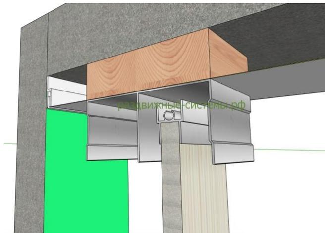
2. Скрытая рельса. Раздвижную систему можно установить как до натяжки потолка, так и после (оставим не большую нишу для установки верхней рельсы).
